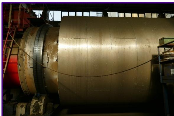
Abbildung 2: In der Trocknungstrommel herrschen bis zu 600 °C. Ein stetiger Luftstrom befördert die trockenen Komponenten Richtung Presse. Dort wird das Grün zu Quaderballen oder Pellets weiterverarbeitet.
