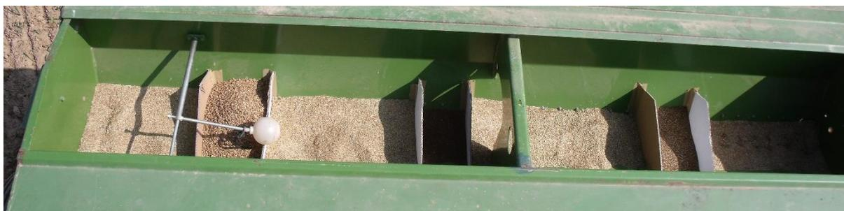
**Bild 3: Blick in den Saatguttank - in diesem Beispiel mit Abtrennungen für drei Streifen**
