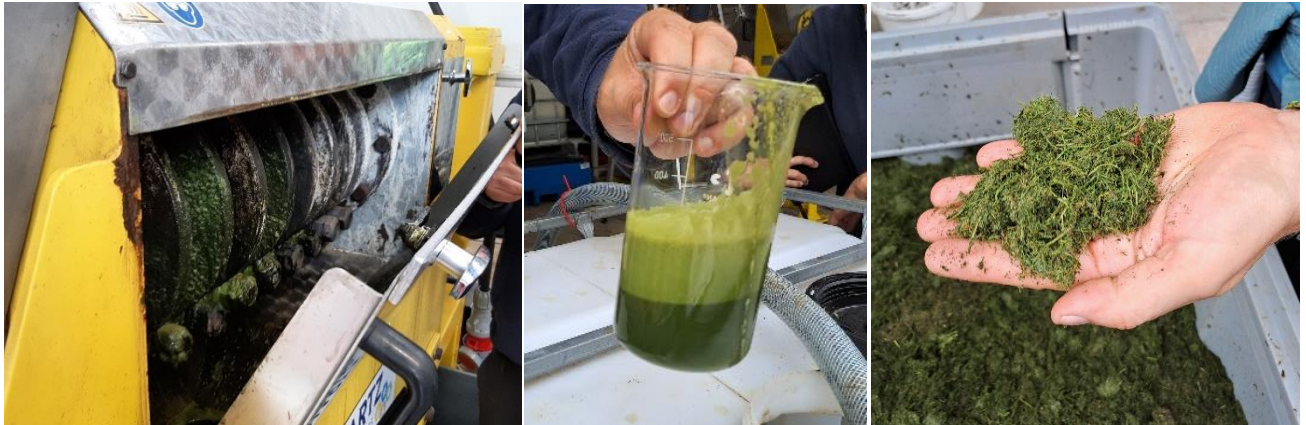
In der Presse entsteht „Grünsaft“ und Presskuchen. Quellen: C. Nieland (1), S. Mátray (2, 3).
