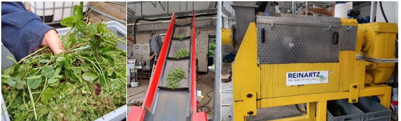
Der Klee gras aufwuchs läuft über ein Förderband in die Schneckenpresse. Quellen: S. Mátray (1, 2), C. Nieland (3).
